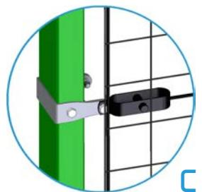
**C** Fixation du câble intermédiaire avec un raidisseur N°4 galvanisé noir. Fixée sur le poteau à l'aide d'une bride inox.
