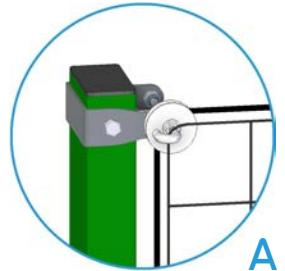
**A** Poule en polyamide Ø62mm, avec crochet de maintien inox pour le filet. Fixée sur le poteau à l'aide d'une bride inox.
