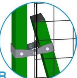
**B** Fixation des jambes de force, à l'aide de brides inox, reliées entre-elles par deux boulons M10.
