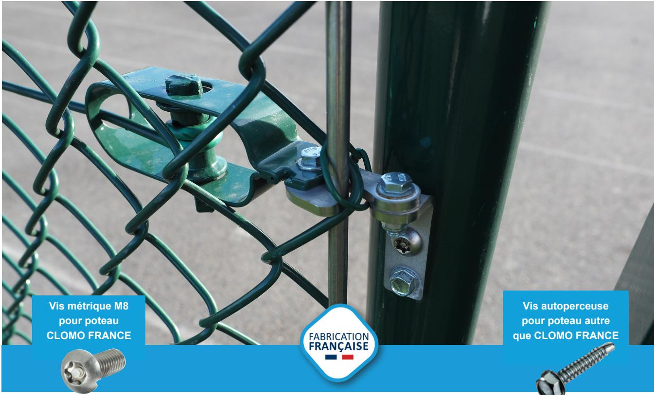
La fixation « CLOMO TECH » orientable simple ou double permet de fixer le(s) raidisseur(s) sur votre poteau et maintenir la barre de tension lors de la pose de vos grillages afin de rigidifier l'ensemble de votre clôture. Elle peut se fixer sur des poteaux ø 60 mm, ø 90 mm ou ø 102 mm et sur des poteaux de section carrée ou rectangle.
